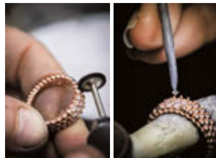
(右)最大3石まで接近して留めることができるネイルセッティングで貴石を固定。貴石同士を密着させることで輝きを際立たせて (左)職人の手で細部まで丁寧に研磨を繰り返して艶やかに
